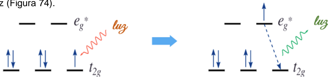
Figura 74. Excitación-relajación de un electrón en orbital d , liberando energía en forma de luz.
