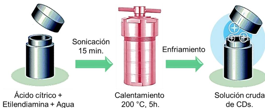
**Figura 27.** Esquema de síntesis de CDs mediante tratamiento hidrotérmico.
