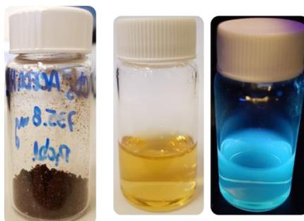
**Figura 29.** Muestra de CDs sintetizados mediante tratamiento hidrotérmico.
