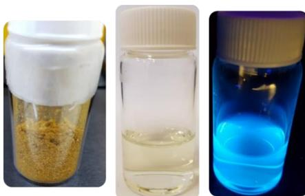
**Figura 39.** Muestra de CDs sintetizados mediante microondas.
