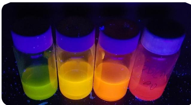
**Figura 54.** Fotografía de QDs CdTe@CA bajo radiación UV.
