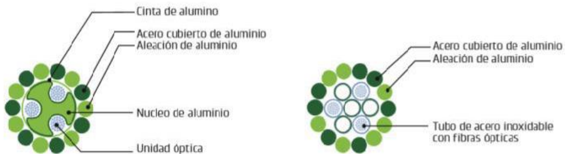
Figura 16. Características del cable de guarda con fibra óptica
