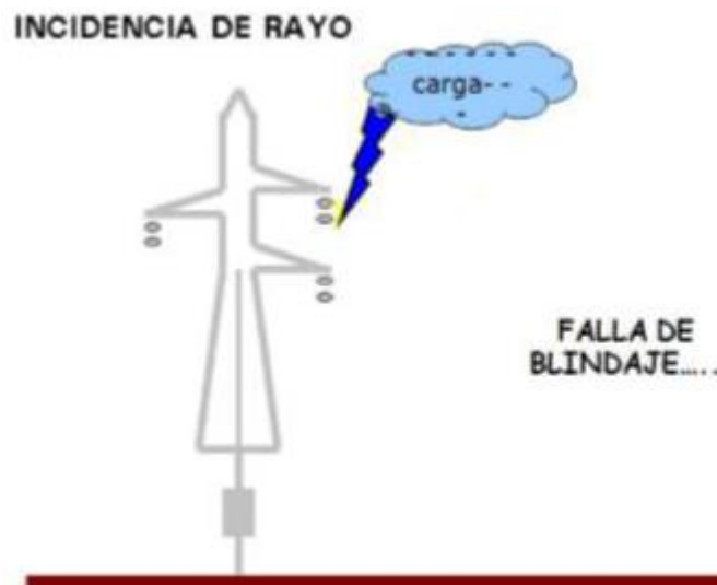
Figura 18. Fallas de Blindaje que producen Flameo/Densidad de Rayos a Tierra y Ángulo de Blindaje promedio considerando terreno plano
