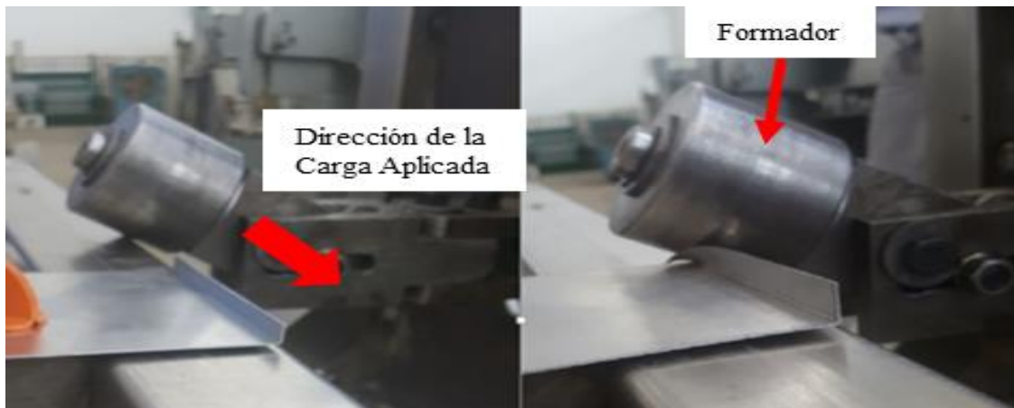
Figura 3.101.- Pre-engargolado Roll Hemming . ELABORACIÓN PROPIA.
