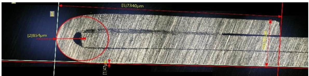
Figura 3.110.- Medición de altura de ceja. ELABORACIÓN PROPIA.
