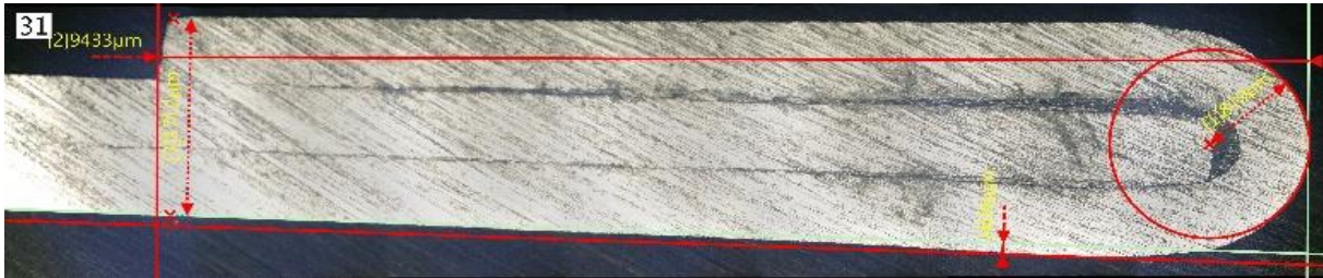
Figura 3.111.- Medición de altura de ceja. ELABORACIÓN PROPIA.
