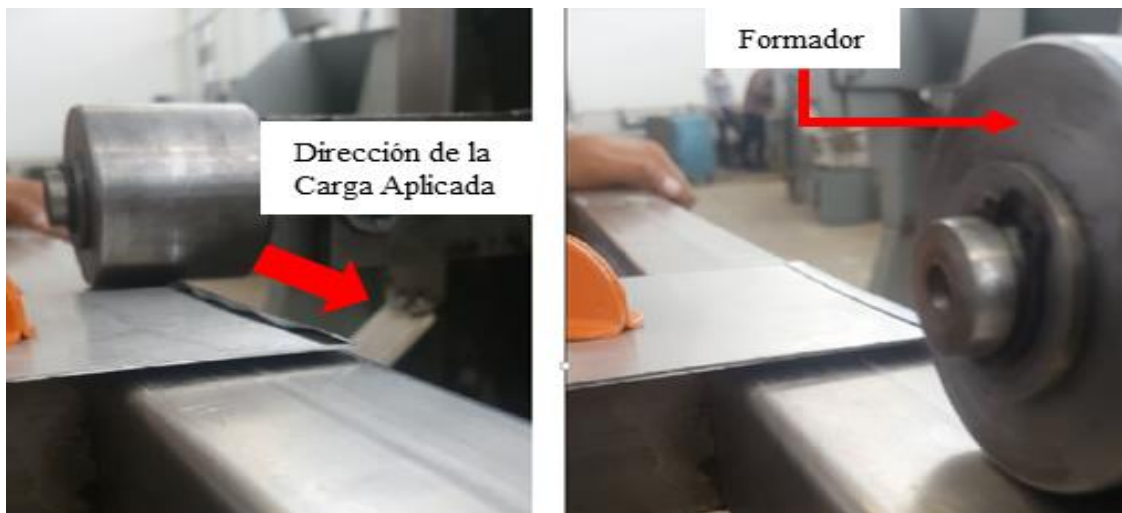
Figura 3.102.- Engargolado final Roll Hemming . ELABORACIÓN PROPIA.
