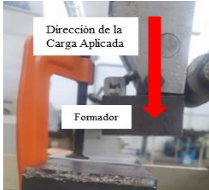
Figura 3.100.- Engargolado final Table Hemming . ELABORACIÓN PROPIA.
