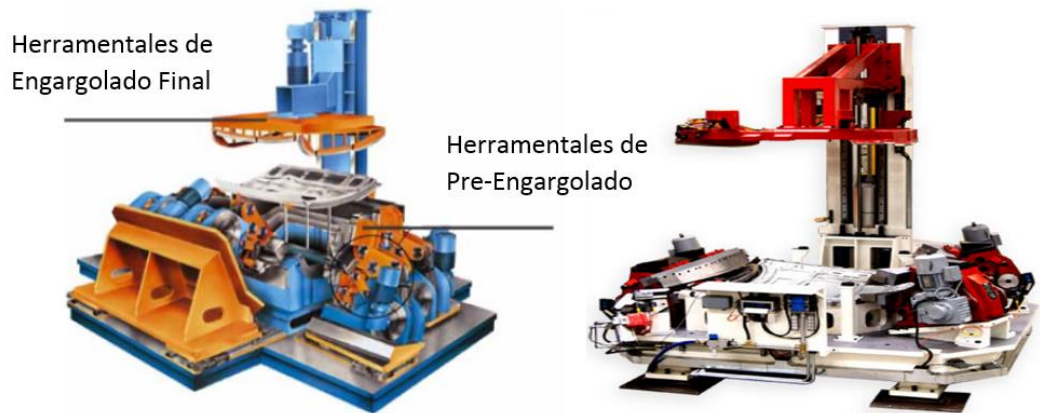
Figura 2.11.- Prensas para engargolar con el método de Table Hemming , [5].
