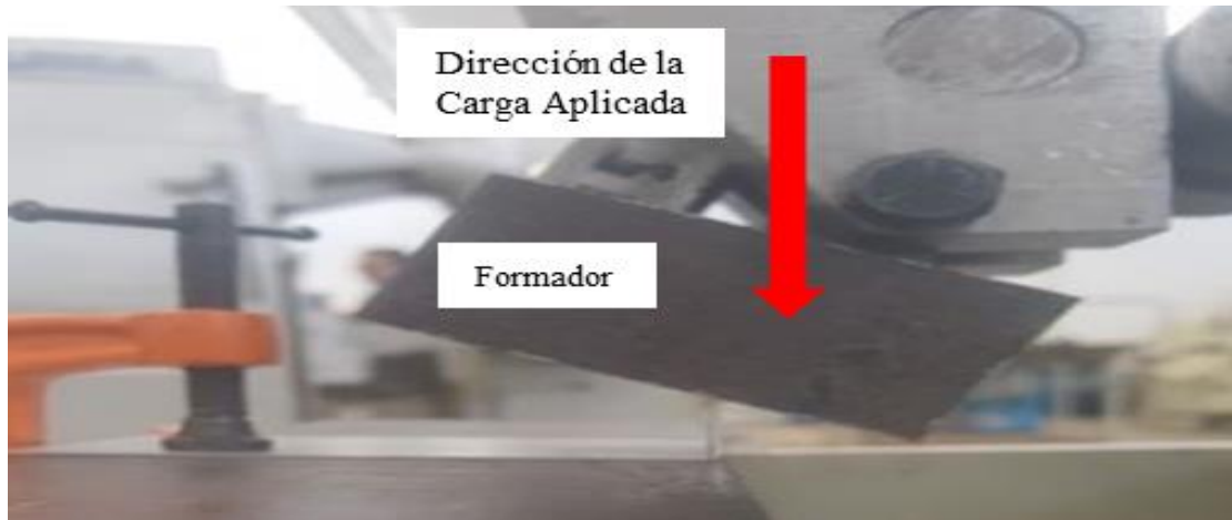
Figura 3.97.- Pre-engargolado Die Hemming . ELABORACIÓN PROPIA.
