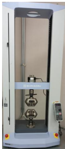
Figura 4.7. Máquina universal para ensayo de tensión.
