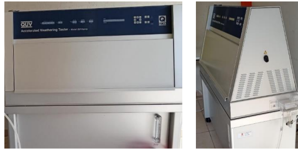
Figura 4.8. Cámara de intemperismo acelerado marca QUV modelo QUV/spray.
