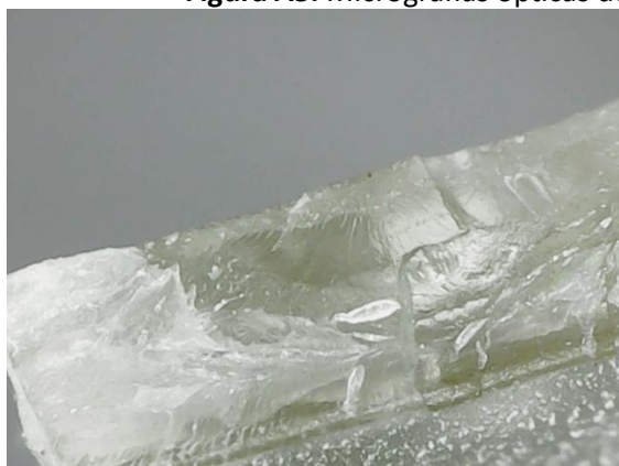
Figura A6. Micrografías ópticas de la ruptura de NCC 5 PMMA 80 PU 20 (2)
