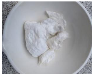
Figura 5.8. Fibra de celulosa seca, obtenida por el medio de separación de agitación.
