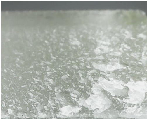
Figura A1. Micrografías ópticas de la ruptura PMMA/PU 50/50
