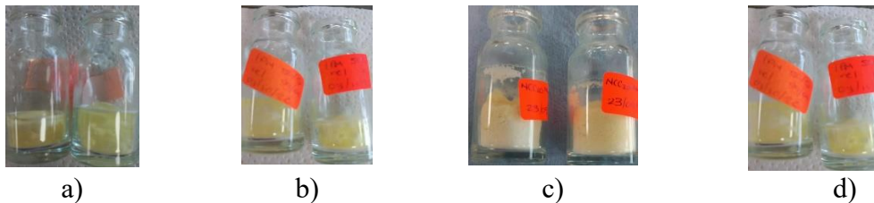
Figura 5.44. Celulosa injertada en MMA 50 PU 50 a) NCC 5 MMA 95 b) NCC 10 MMA 90 , c) NCC 20 MMA 80 , d) NCC 30 MMA 70 en relación 90/10 injerto.
