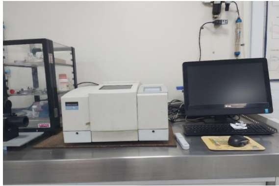
Figura 2.9. Espectrofotómetro Perkin Elmer Spectrum One.
