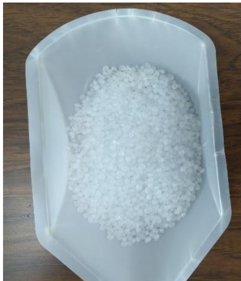
Figura 2.5. Polipropileno Profax 6231 en forma de pellet.
