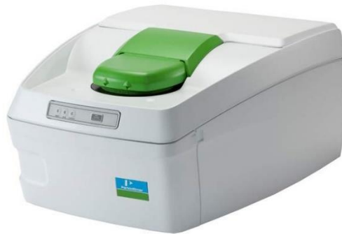
Figura 2.13 Equipo de Calorimetría Diferencial de Barrido Perkin Elmer DSC 8000.
