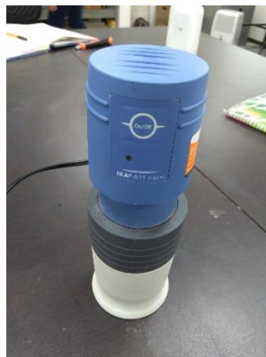
Figura 2.4. Molino IKA A11 Basic.
