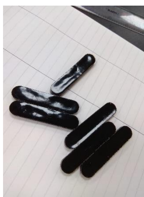
Figura 2.8. Probetas de las mezclas de PP con partículas de sargazo.
