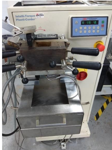
Figura 2.6. Cámara de mezclado Intelli-Torque Plast-Corder Rheometer marca Brabender.
