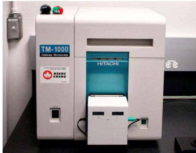
Figura 2.16 Equipo de Microscopía Electrónica de Barrido Hitachi TM-1000 Tabletop Microscope.
