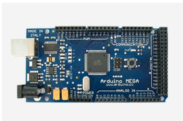
Fig. 2.17 Placa del *Arduino Mega*
