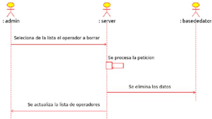
Fig. 4.13 Diagrama de secuencia "Borrar operador de la BD"
