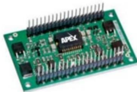
Figura 2.4.-Circuito Integrado Híbrido de capa gruesa.
