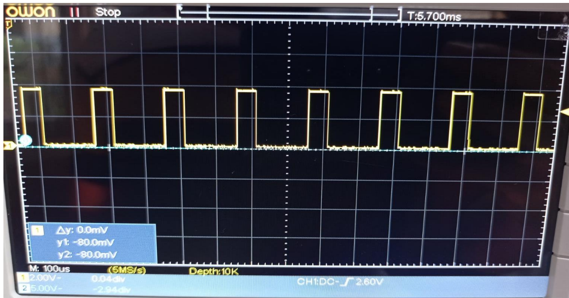
Figura 3.13.-Señal eléctrica en la salida del Oscilador Astable y en la entrada del Transmisor TLP434A sin sobrecarga dentro del circuito sensor y transmisor.
