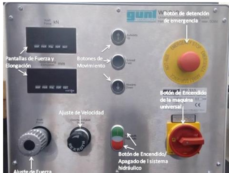
Figura 2. 16 Descripción de Tablero de Control Maquina Universal Gunt Hamburg WP310
