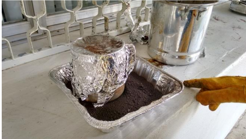
Figura 2. 4 Carbón después del proceso de activación artesanal
