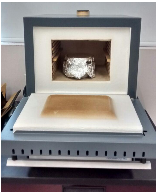
Figura 2. 9 Introducción de la muestra a la mufla para someterse al proceso de pirólisis con temperatura controlada a 360 °C
