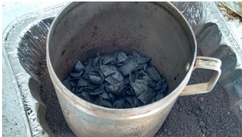
Figura 2. 5 Apariencia de la biomasa residual después del proceso de pirólisis artesanal
