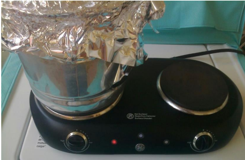
Figura 2. 2 Arreglo Pirolítico para la obtención de carbón vegetal
