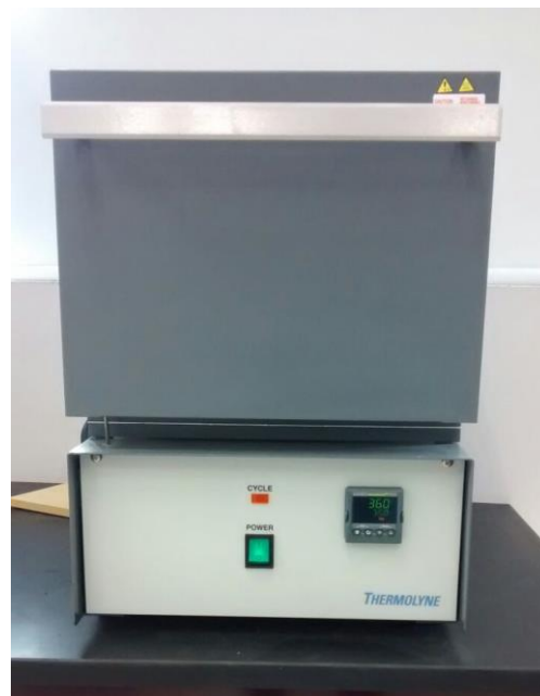
Figura 2. 9 Introducción de la muestra a la mufla para someterse al proceso de pirólisis con temperatura controlada a 360 °C
