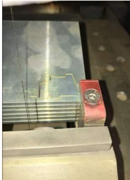
Figura 67. Corte de insertos, mecanizado con alambre de latón de 0.010 in
