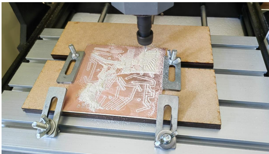
Figura 92. Grabado de placa fenólica con CNC 3018 Pro
