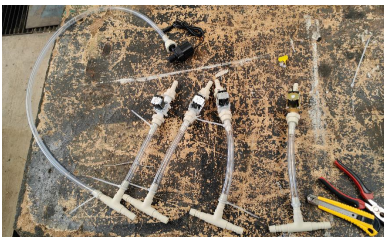
Figura 104. Conexión de sistema hidráulico con válvulas solenoides.
