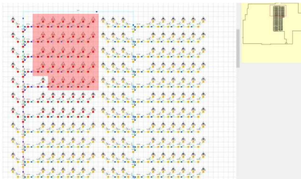
Figura 5.6 Área remota analizada R3. Fuente: Software PIPENET
