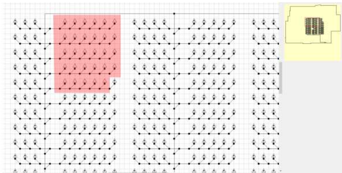
Figura 5.6 Área remota analizada R2. Fuente: Software PIPENET
