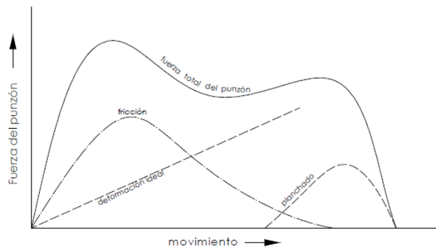
Figura 2.4- Fuerza del punzón contra el movimiento del punzón en un embutido profundo (Campos Vázquez, 2013)
