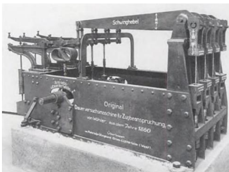
Figura 1. 2 Máquina de Wöhler. Museo de Munich [6].
