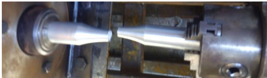
Figura 4. 9 Ruptura de probeta de aluminio 6061-T6
