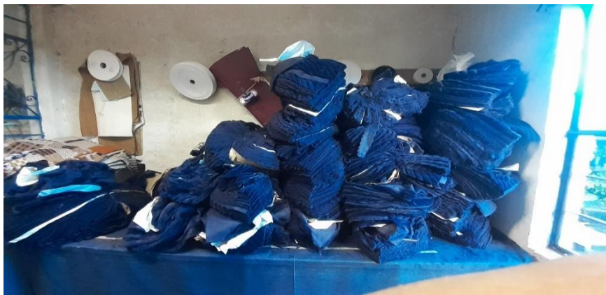
Figura 26: Separación de corte en el almacén por tallas
