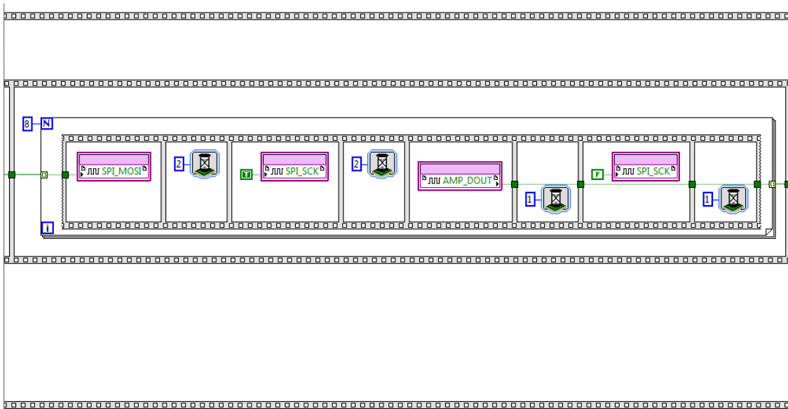
Figura 3.6. Contador hasta 8 para terminar de configurar el preamplificador
