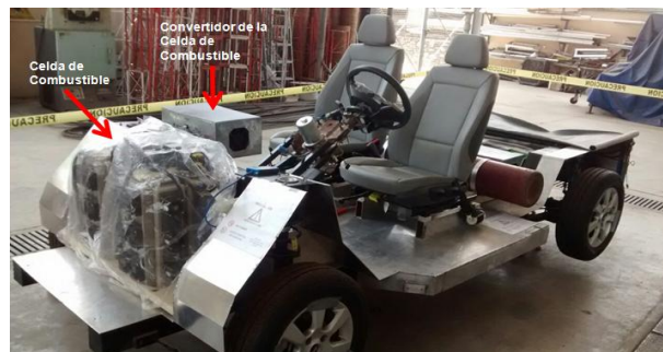
Figura 3.14. Ubicación de la celda de combustible y su convertidor.
