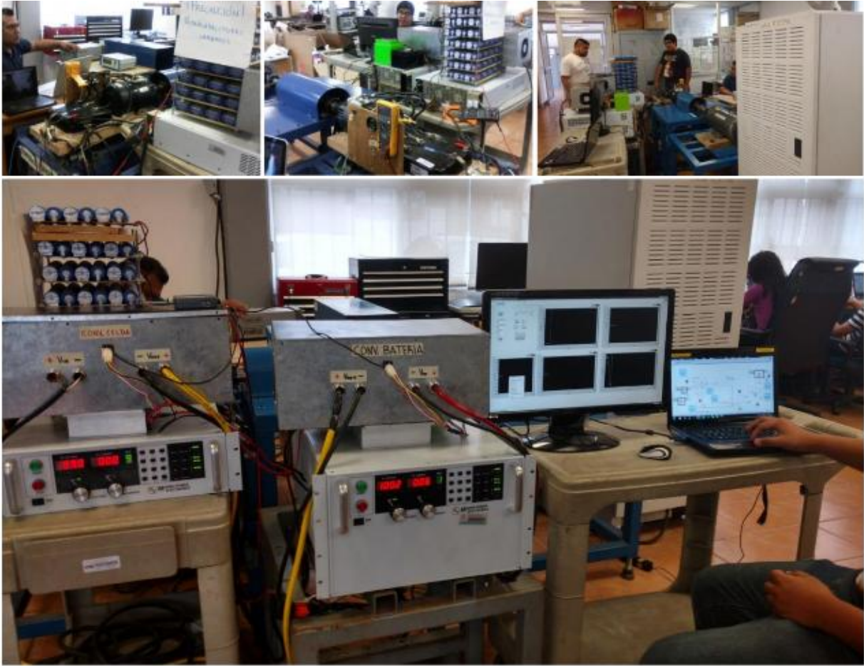
Figura 4.3. Banco de pruebas implementado en laboratorio.
