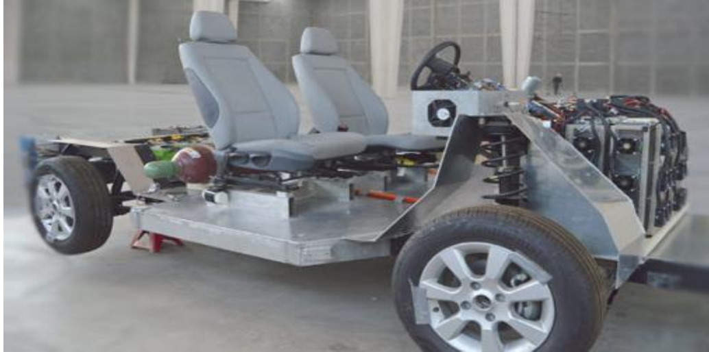
Figura 4.2. Ensamble final del vehículo eléctrico.
