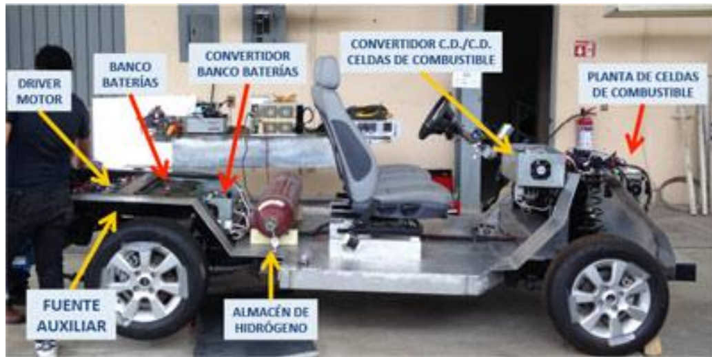
Figura 3.17. Vehículo eléctrico y distribución del sistema de potencia híbrido.
