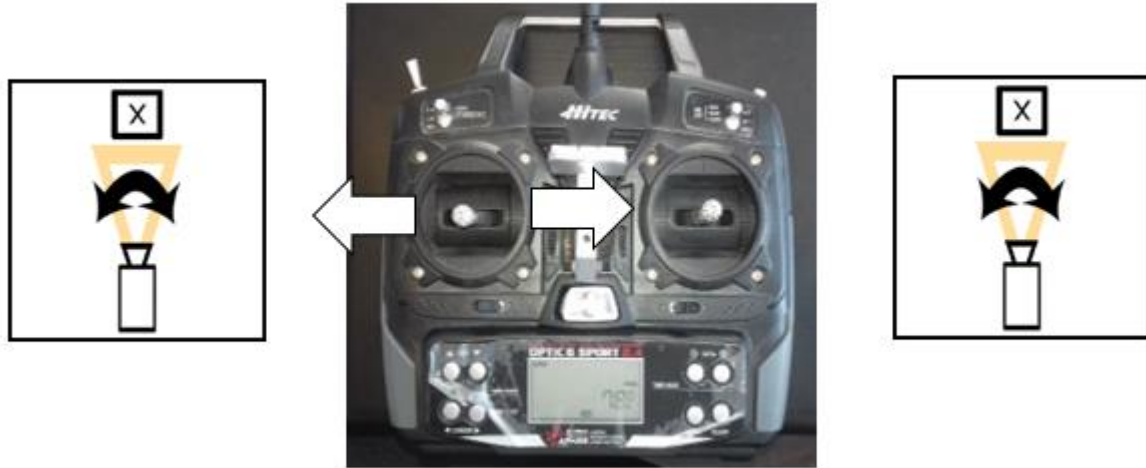
Imagen 3.0.20 Control de rotación sistema Pant&Tilt sistema de visión.
