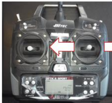
Imagen 3.0.16 Control de movimiento izquierda/derecha del robot.
