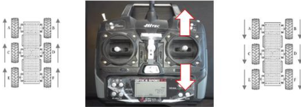
Imagen 3.0.15 Control de movimiento adelante/atrás con el transmisor RC.
