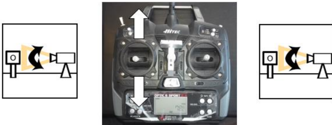
Imagen 3.0.21 Control de elevación sistema Pant&Tilt sistema de visión.
