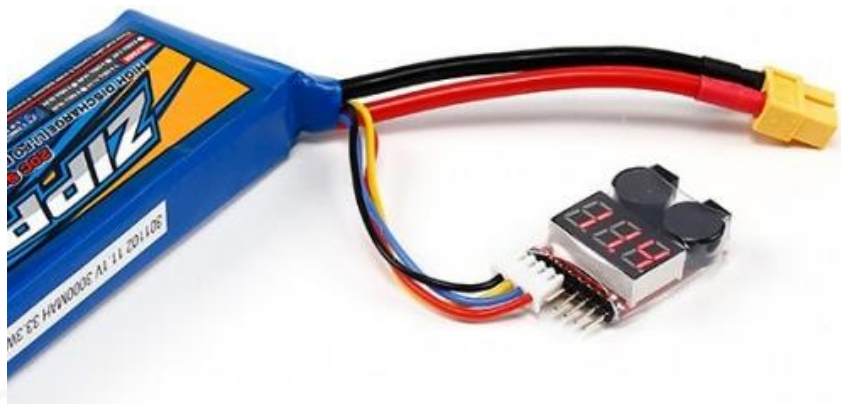
Imagen 3.0.36 Conexión eléctrica del indicador de batería.
