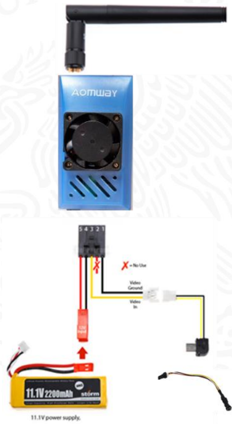
Imagen 3.0.24 Conexión eléctrica del trasmisor AOMWAY®.
