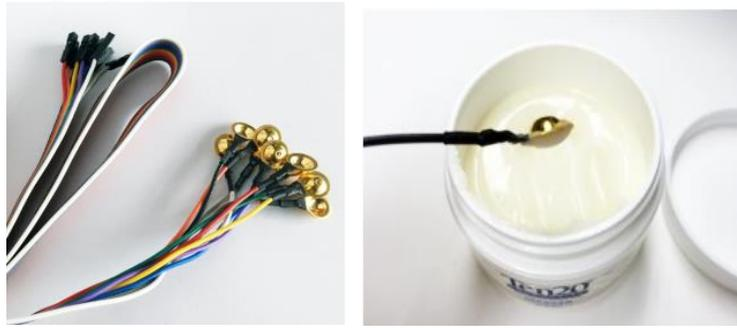
Figura 4.3 Electrodo de copa de oro y pasta conductiva
