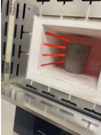
**Figura 65.** Crisol a 300°C dentro de la mufla.
