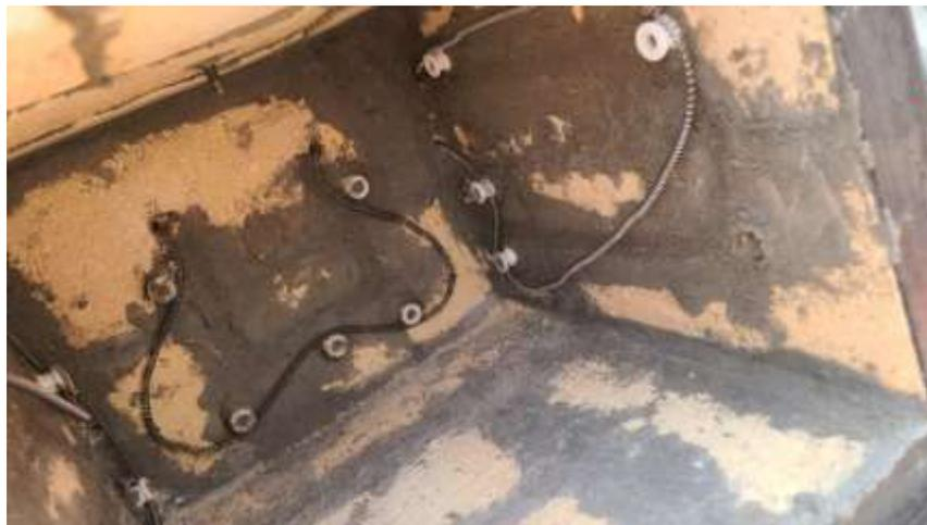
**Figura 51.** Resistencias calibre 18 y termopar tipo K instalados.
