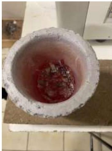
**Figura 66.** Aluminio a una temperatura estimada de 600°C.
