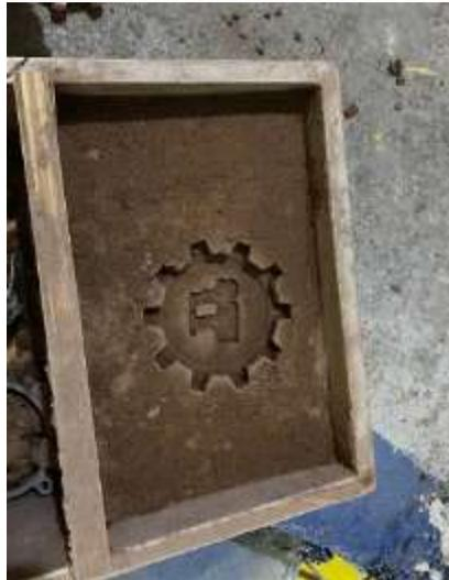
**Figura 63.** Molde de arena para fundición de aluminio.
