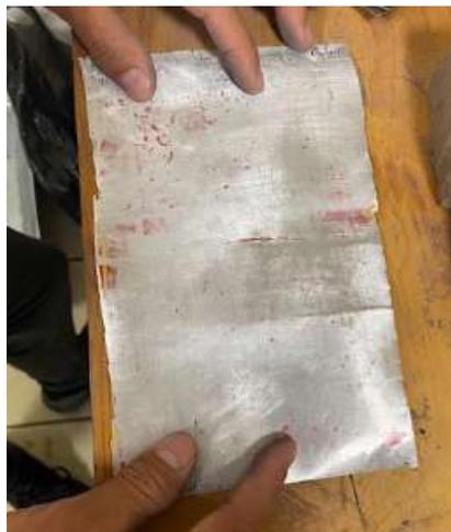
**Figura 22.** Lata cortada y posteriormente lijada y limpiada.
