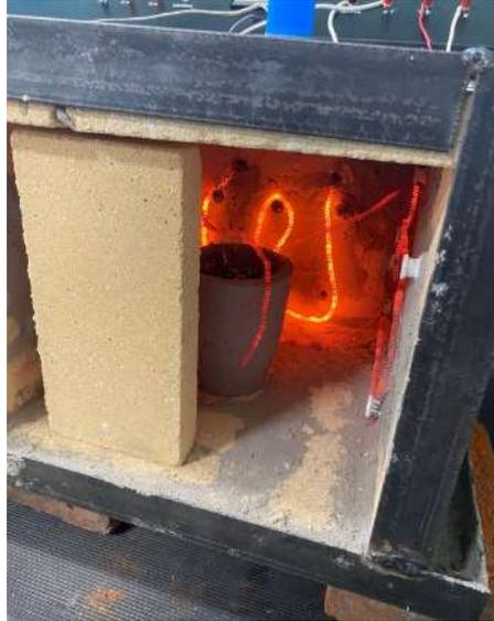
**Figura 56.** Aislamiento de la cámara interna del horno.
