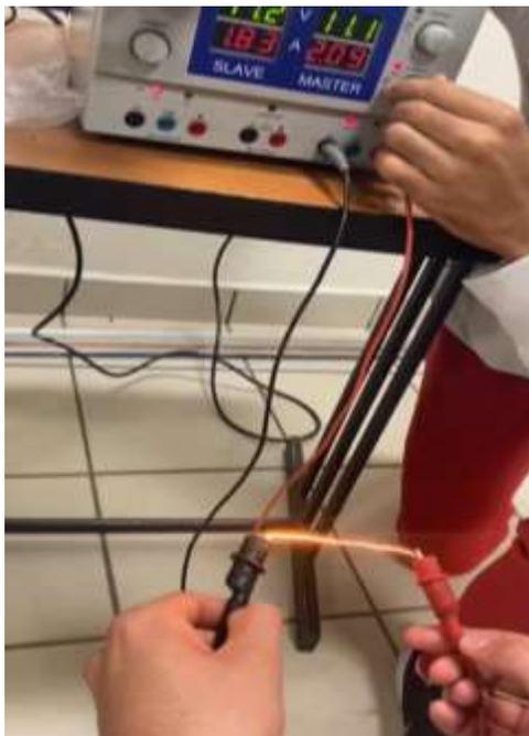
**Figura 29.** Inducción de corriente al alambre a través de una fuente de voltaje.
