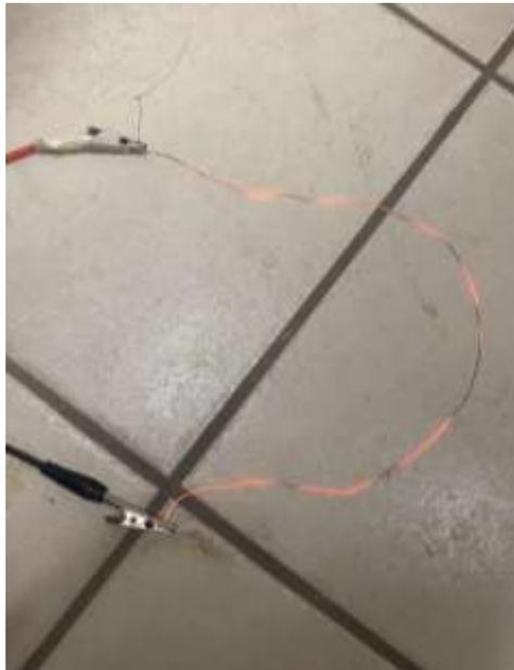
**Figura 30.** Segundo trozo de alambre sometido a una corriente eléctrica.
