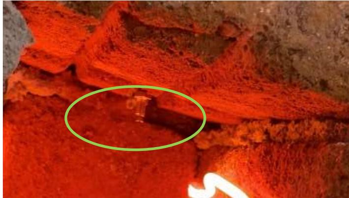
**Figura 42.** Termopar incrustado en la cámara del horno.
