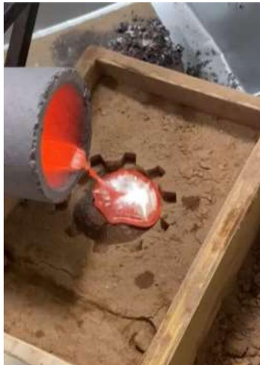
**Figura 28.** Vertido del material en estado líquido.
