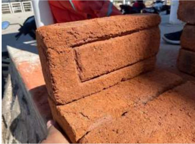
**Figura 31.** Ladrillo ranurado en forma "C".
