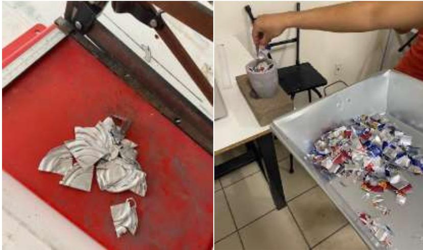
**Figura 23.** Latas trozadas por medio de una guillotina.
