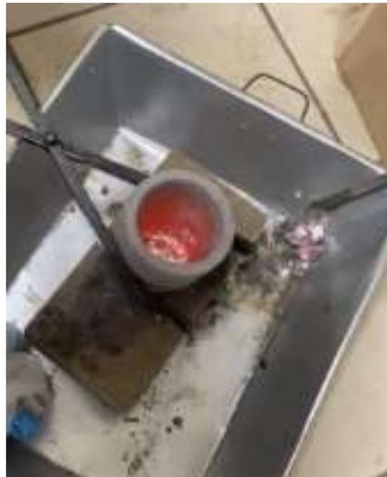
**Figura 79.** Fundición de latas procesadas.
