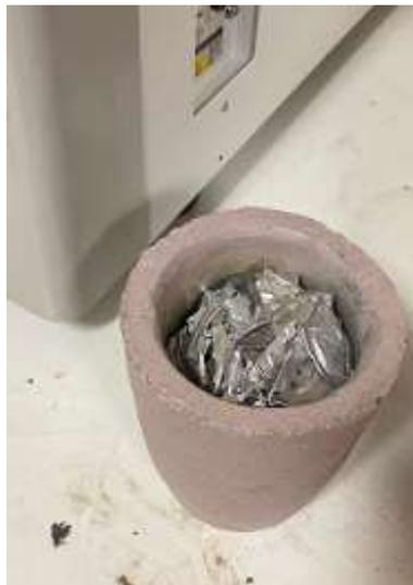
**Figura 25.** Trozos de aluminio comprimidos en un crisol.
