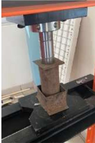
**Figura 24.** Trozos de lata comprimidos por medio de una prensa hidráulica.
