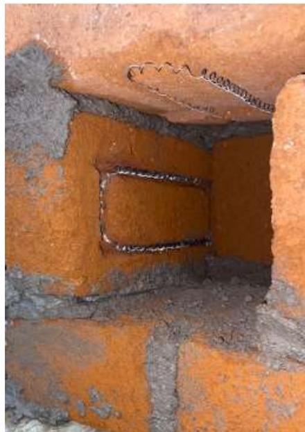
**Figura 38.** Terminales de las resistencias incrustadas en la cámara.
