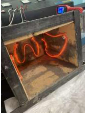
**Figura 52.** Resistencias eléctricas en funcionamiento.
