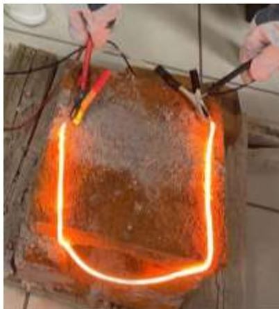
**Figura 70.** Resistencia eléctrica conectada a 120v.
