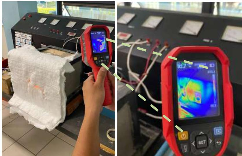
**Figura 57.** Temperatura exterior de horno.
