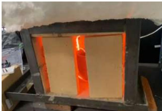
**Figura 59.** Extracción del crisol y enfriamiento del horno.
