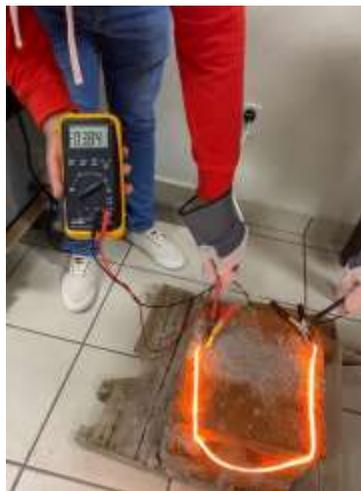
**Figura 41.** Amperaje de corriente a través de la resistencia comercial.
