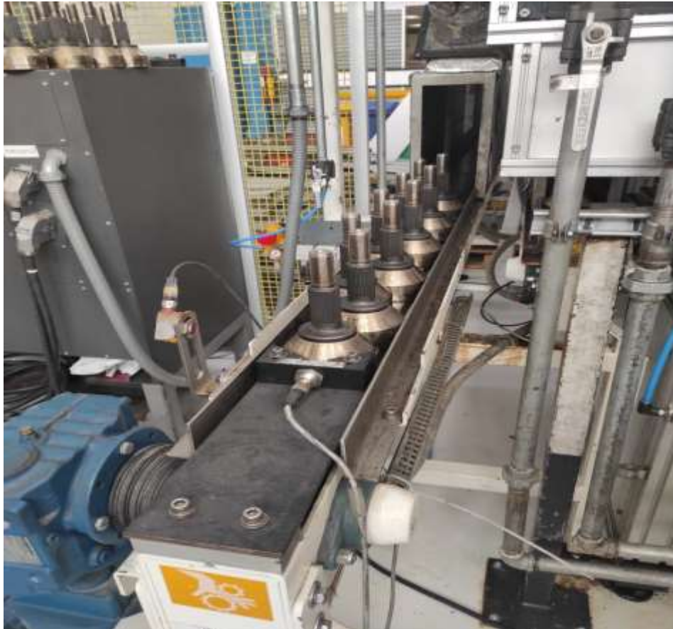
Figura 12. Salida de Campanas una vez concluyendo su proceso de revenido
