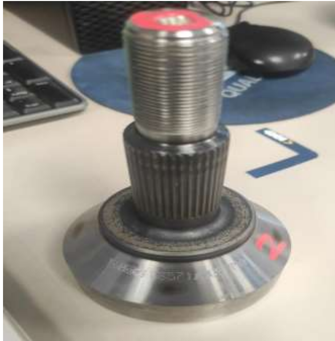
Figura 21. Campana identificada con sus siglas particulares ya con su mejora aplicada y aprobada por el área de calidad
