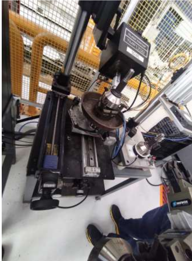
Figura 22. Estampadora reubicada y con sus mejoras aplicadas de programación
