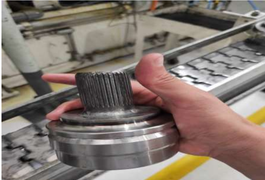
Figura 10. Campana proveniente de Op 70 ya con su debido tratamiento térmico
