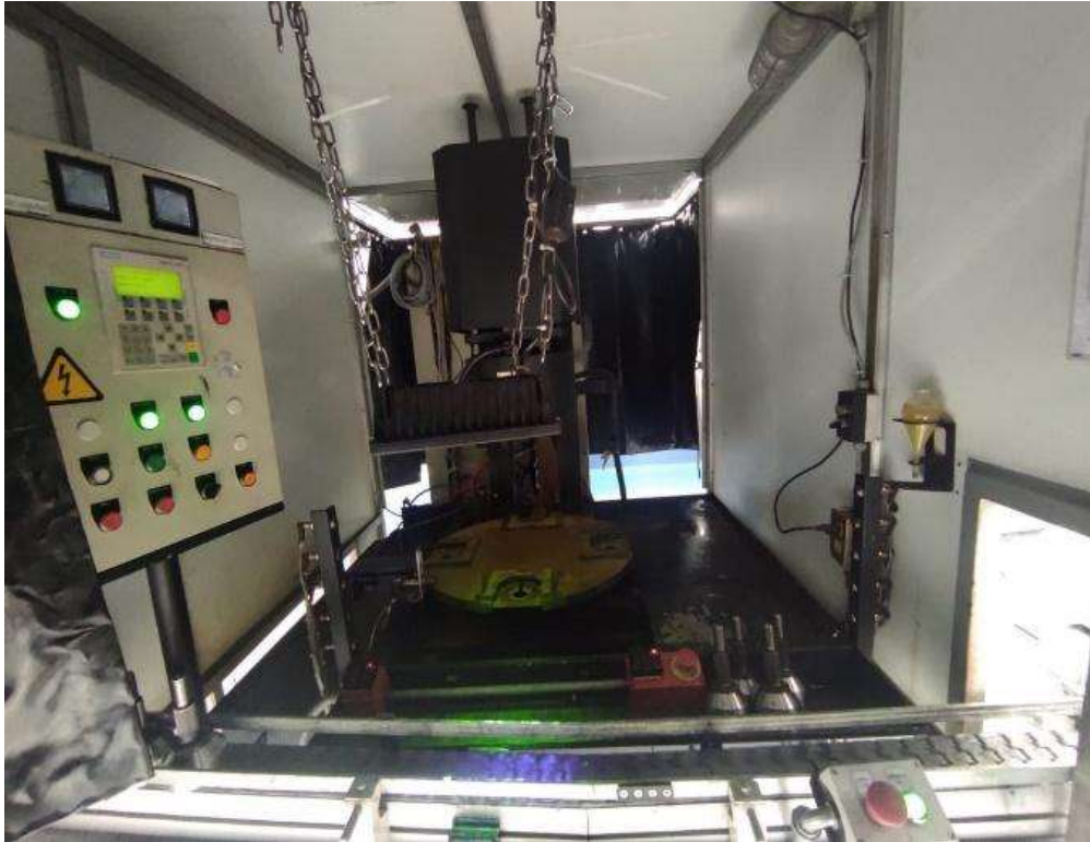
Figura 11. Cuarto de inspección de fisuras mediante lámpara que emite luz uv directo a la pieza
