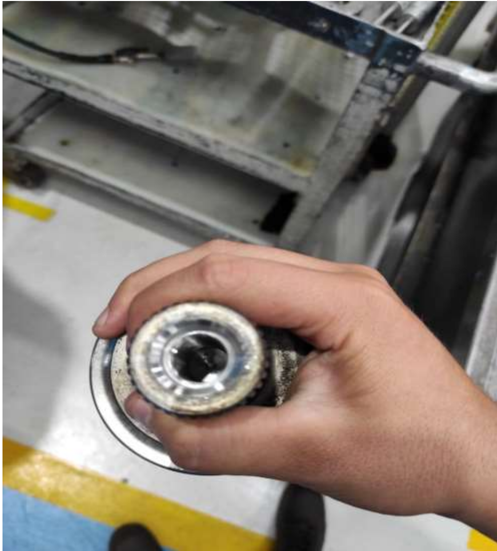
Figura 15. Campana barrenada y con anticorrosivo
