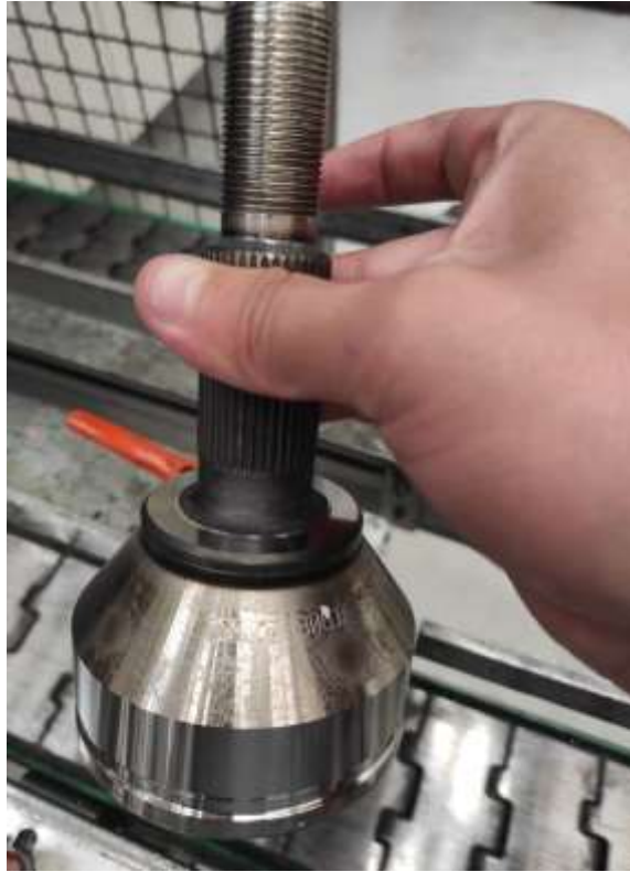
Figura 13. Campana proveniente de op.110 rectificada final
