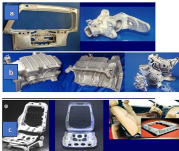
Figura 8. Ejemplos de componentes automotrices de aleaciones de magnesio, a) marco de la puerta, b) colector de aceite, c) estructura del asiento. [18]
