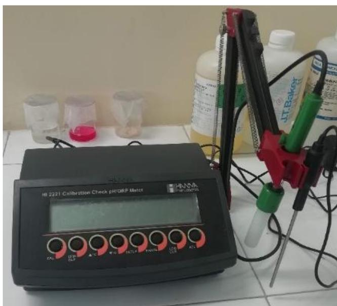
Figura 22. pH metro, marca HANNA instruments modelo HI2221.
