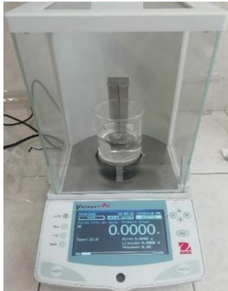
Figura 18. Balanza analítica Voyager Pro y kit de densidad.
