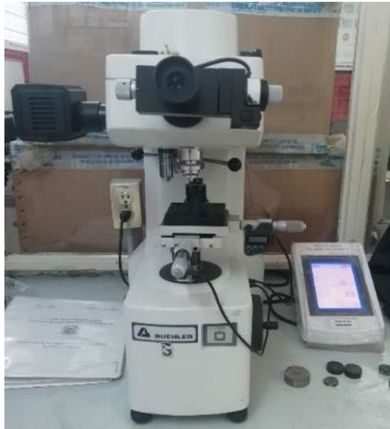
Figura 19. Microdurómetro, Buehler Micromet 5103.
