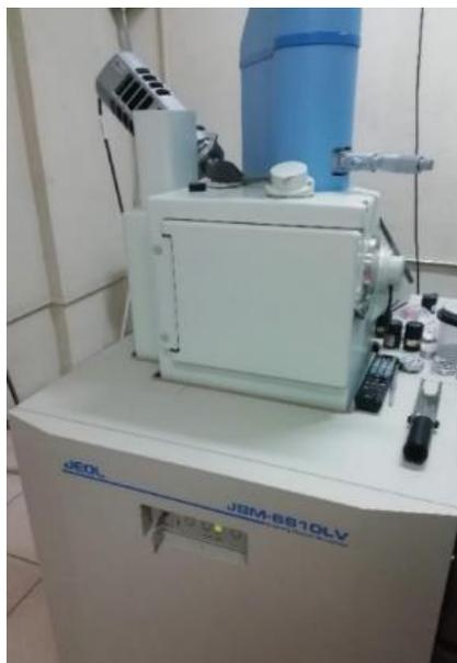
Figura 14. Microscopio Electrónico de Barrido, equipo JEOL JSM-6610L.
