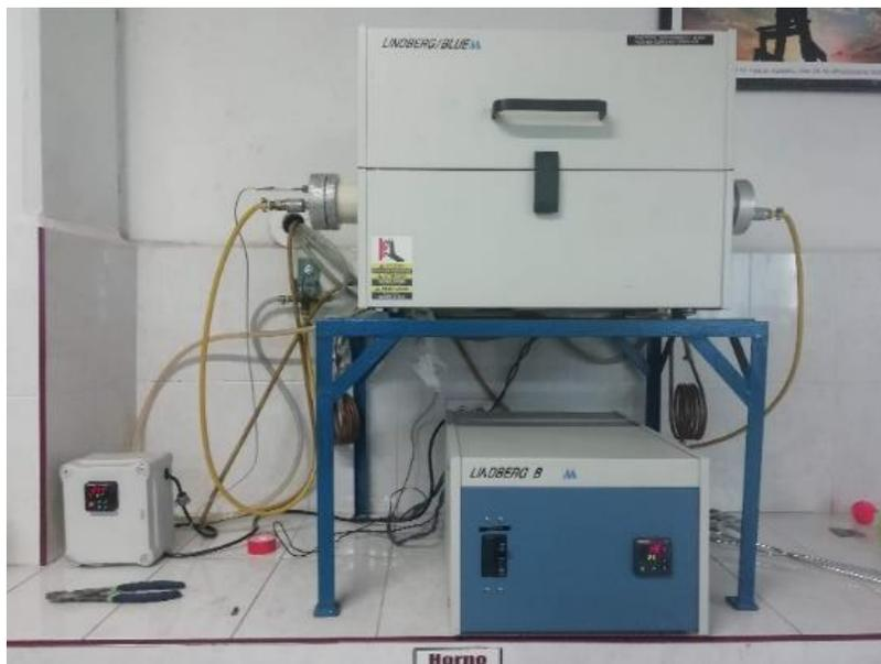
Figura 13. Horno tubular para el proceso de sinterización.
