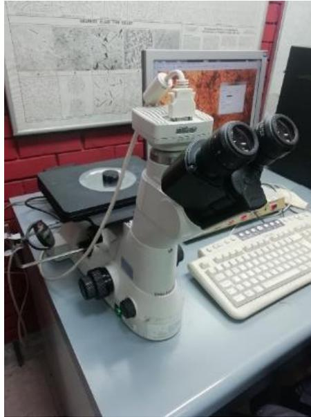
Figura 16. Microscopio Óptico, marca Nikom eclipse MA100
