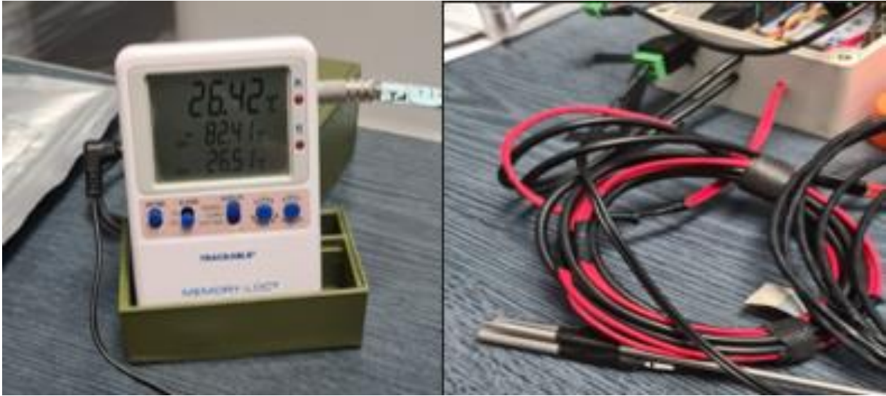
Figura 16. Termómetro patrón digital para calibración de sensores y sensores DS18B20 respectivamente, autoría propia, 2023.
