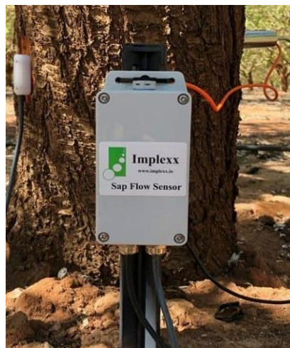
Figura 2. Sensor de flujo de savia digital SDI-12 en campo, https://blog.biofisicaambiental.com/sensor-de-flujo-de-savia-implexx
