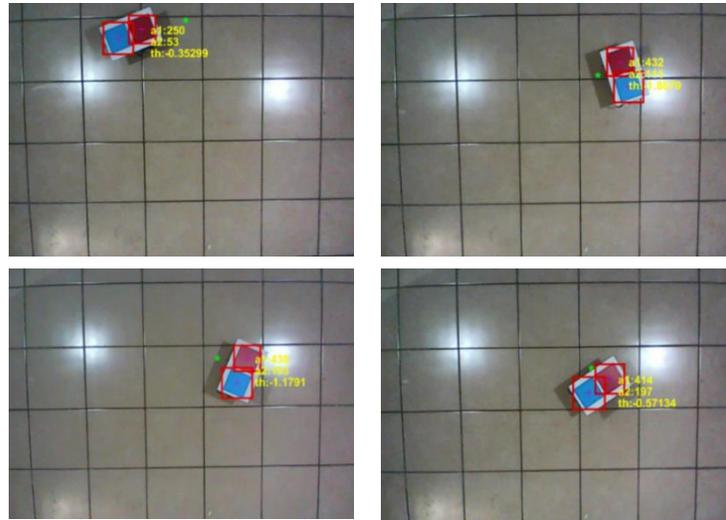
Figura 39 Seguimiento de trayectoria visión artificial
