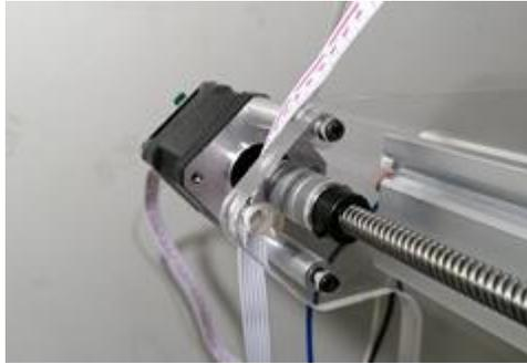
Figura T8: ensamblaje del tornillo ACME.
