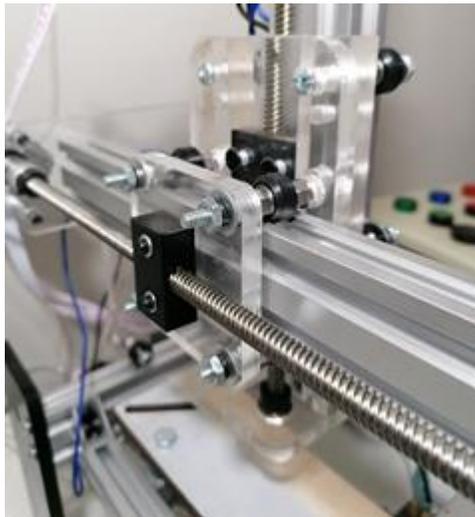
Figura T7: parte posterior del carro del eje X.
