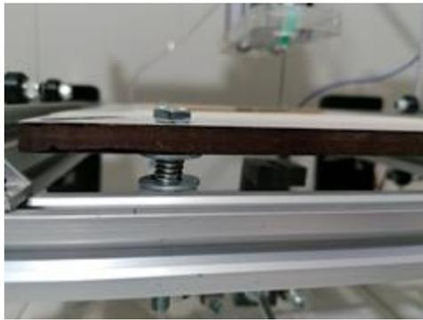
Figura T9: mecanismos de nivelación de la cama y sustrato.
