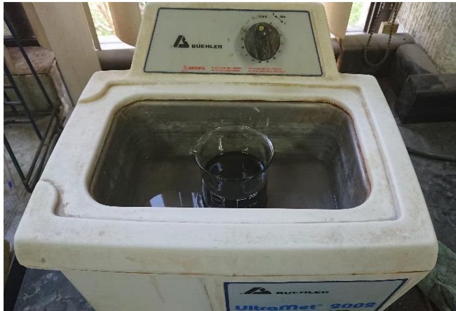
Figura 19. Tina de ultrasonido, Sonificación del nanofluido. Atlas fotográfico, Proyecto Cidesi-ITQ.
