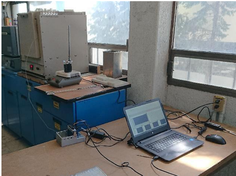
Figura 27. Instrumentación del proceso de Temple, de izquierda a derecha, Mufla, Plato caliente con Nanofluido, Tarjeta de adquisición de datos y Labview (software). Atlas fotográfico, Proyecto Cidesi-ITQ.
