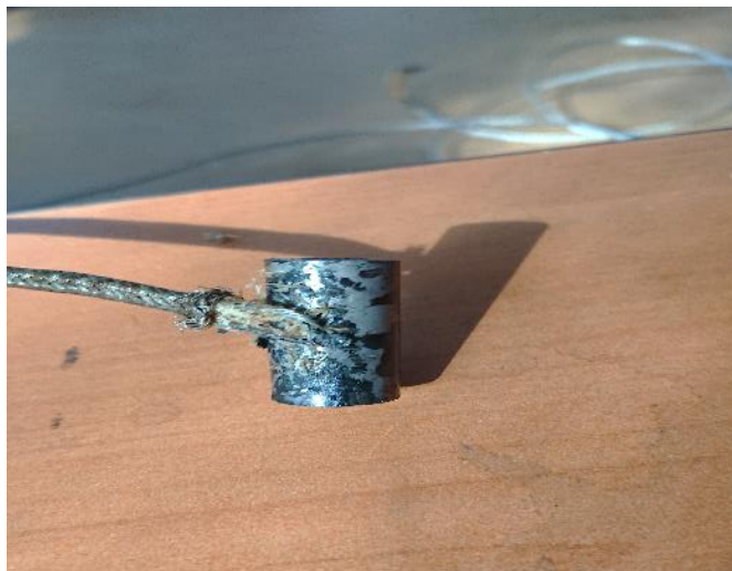
Figura 26. Probeta de acero con termopar soldado, después del proceso de temple. Atlas fotográfico, Proyecto Cidesi-ITQ.
