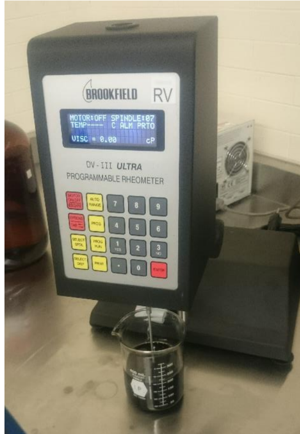
Figura 20. Reómetro Brookfield, medición de la viscosidad del Nanofluido. Atlas fotográfico, Proyecto Cidesi-ITQ.
