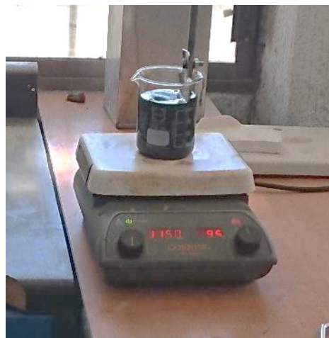
Figura 18. Plato caliente para agitado mecánico del nanofluido. Atlas fotográfico, Proyecto Cidesi-ITQ.
