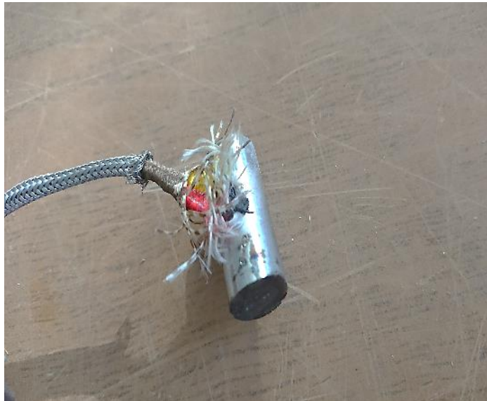
Figura 25. Probeta de acero con termopar soldado. Atlas fotográfico, Proyecto Cidesi-ITQ.
