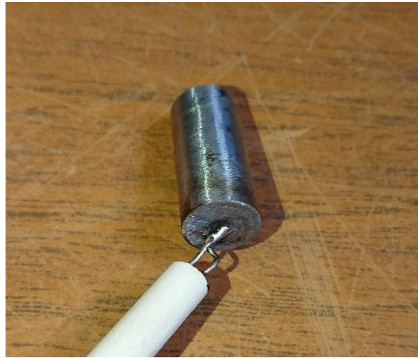
Figura 23. Probeta de acero con termopar soldado, antes del proceso de temple. Atlas fotográfico, Proyecto Cidesi-ITQ.
