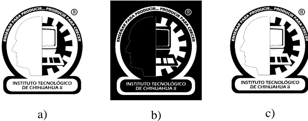
Figura 3.3 a) Binarización estándar, b) Binarización inversa y c) Binarización Otsu. Obtenido en: Elaboración propia.
