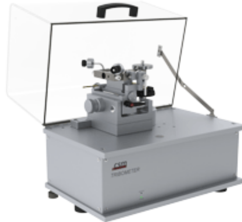
Figura 3.8 Tribómetro CSM Instruments con configuración pin-on-disk.
