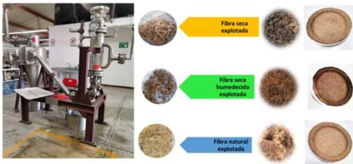
Figura 2.- Equipo de explosión de vapor, fibras antes y posterior al tratamiento y moldes elaborados a base de residuos de la agroindustria con tratamiento por explosión de vapor.
