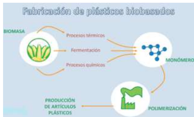
Figura 1.- Proceso de fabricación de plásticos biobasados.
