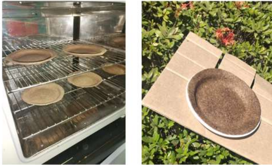
Figura 5.- Proceso General del secado en estufa y a temperatura ambiente del recubrimiento con el molde biodegradable. (Colorado, M. et al 2019).
