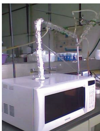
Figura 8. Equipo de extracción adaptado por Rojas-Olivos (2009). Imagen obtenida de: https://acortar.link/fL9Nt .
