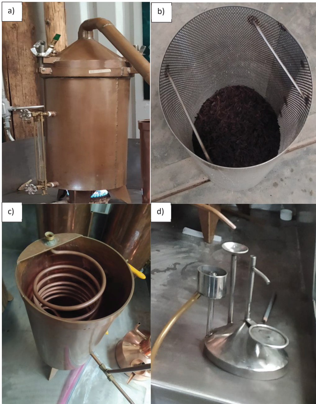
Figura 17. Estructura del alambique de cobre. a) barril, b) maya cilíndrica, c) refrigerante, d) separador de fases.
