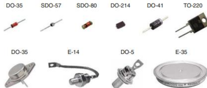
Figura 10, Tipos de encapsulados de los diodos. Nota: recuperada de [10].
