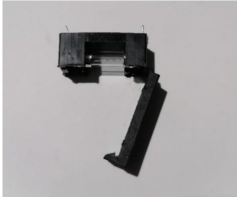
Figura 62, Fusible con portafusibles.
