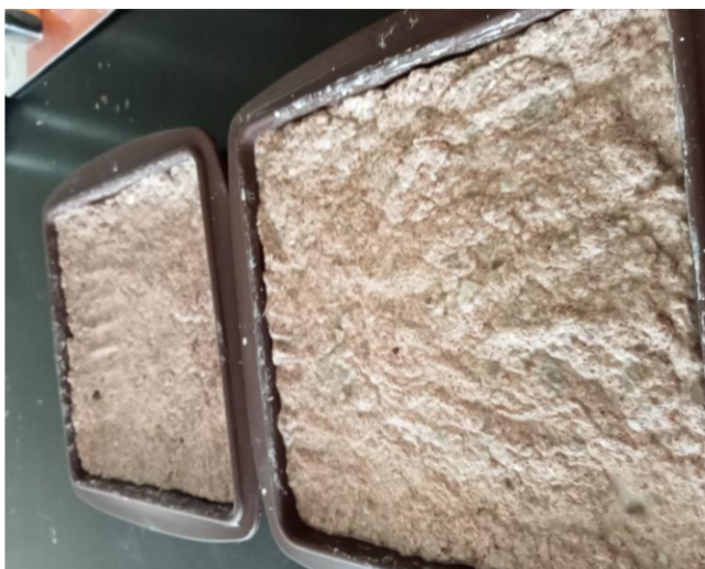
Figura 6-26. La mezcla colocada en los moldes.
