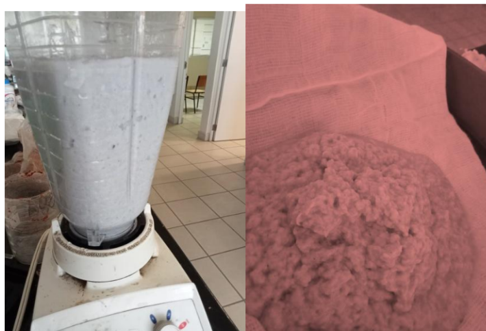
Figura 6-24. Izquierda; titulación de las hojas de papel. Derecha: Filtración de exceso de agua en las hojas.
