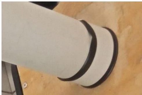
Figura 6-29. Adecuación de la tapa en un extremo del tubo de PVC.
