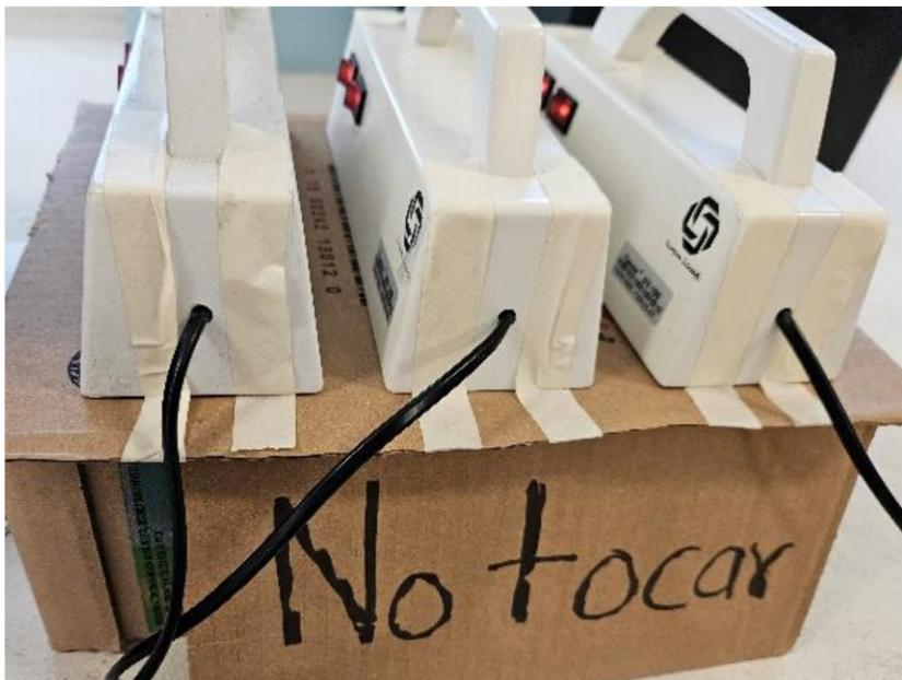
*Figura 7. Sistema utilizado en la prueba de solidez a la luz UV.*
