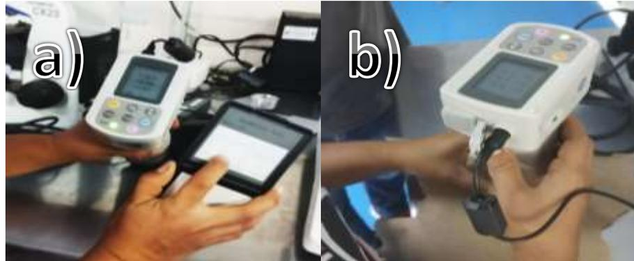
Figura 6.- a) Calibración del colorímetro y b) Análisis a las muestras.
