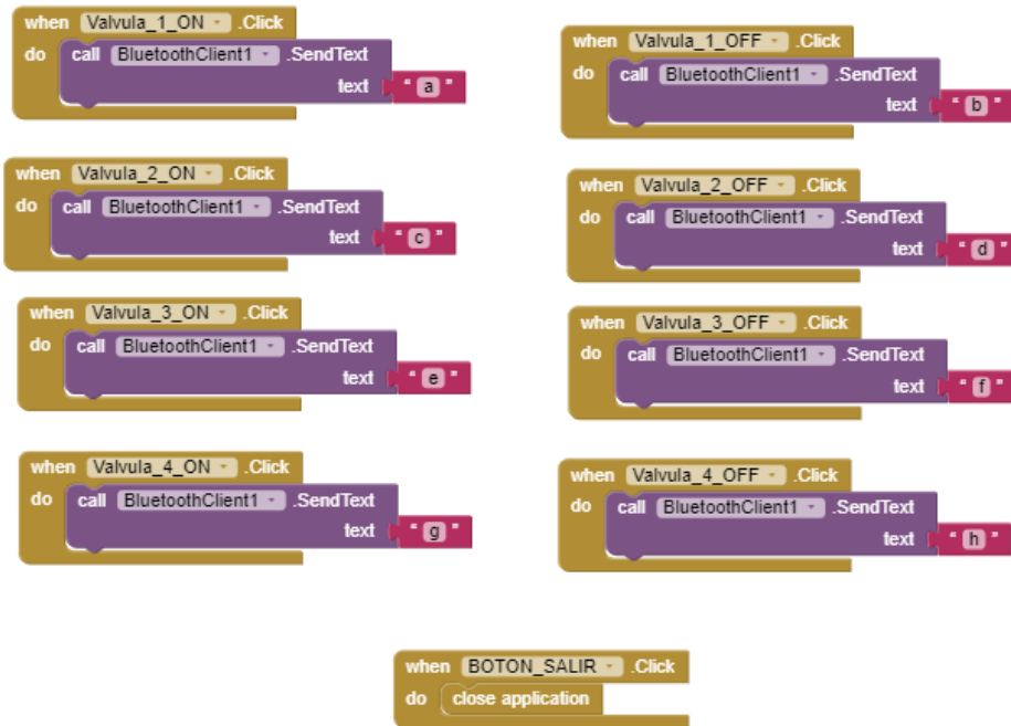
Figura 34 Conjunto de bloques para el envío de letras a módulo HC-05
