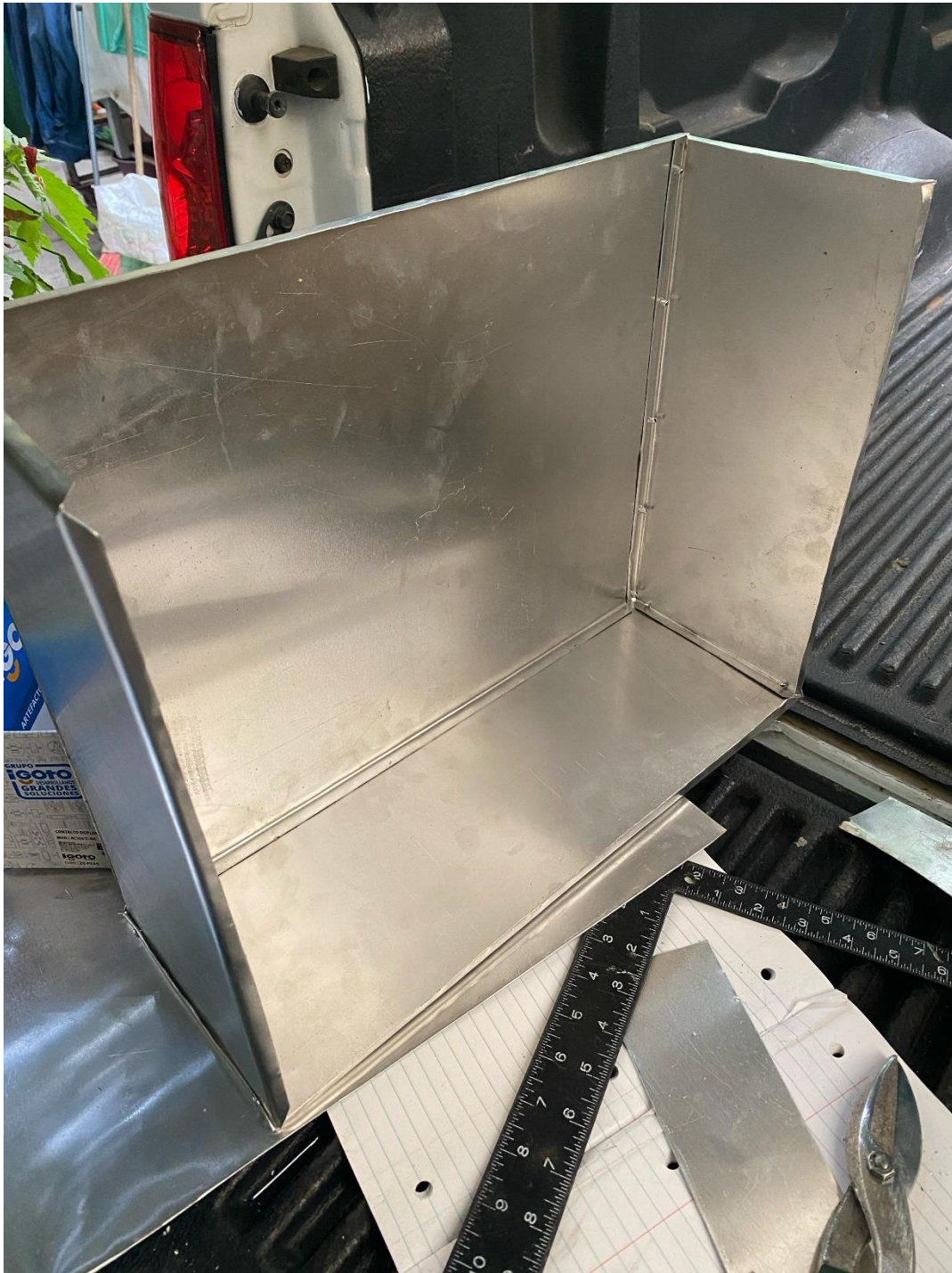
Figura 42 Armado de gabinete etapa de control y potencia
