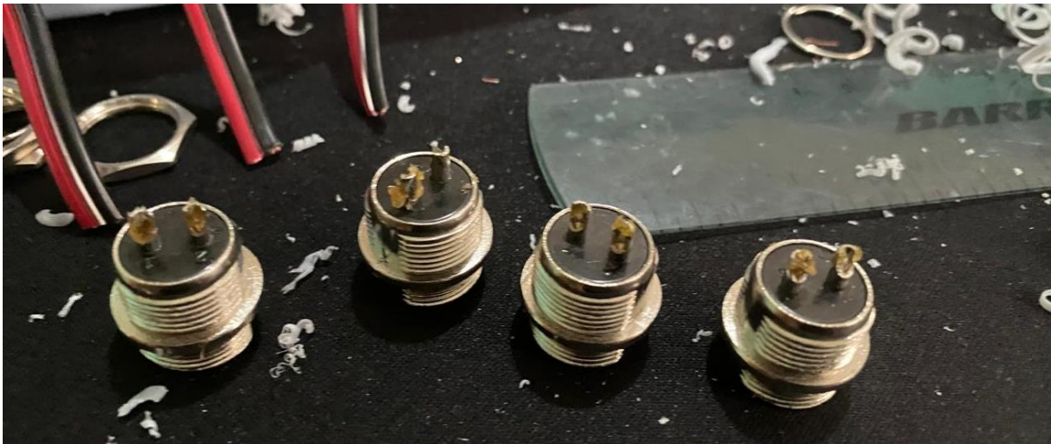
Figura 28 Armado de conectores circulares
