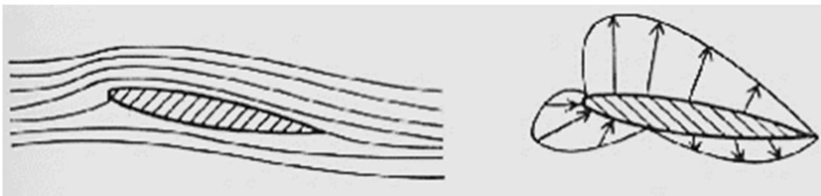
Fig. 6. Un perfil con una ligera inclinación en su ángulo de ataque, [14].
