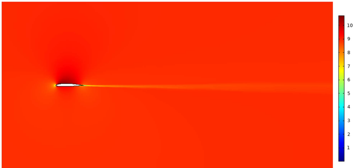
Fig. 65. Comportamiento de la formación de la capa límite y de la turbulencia sobre el perfil SG 6041.
