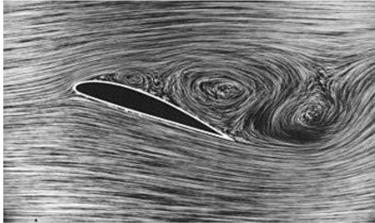
Figura 3.7 Flujo separándose de un perfil aerodinámico a un alto ángulo de ataque.
