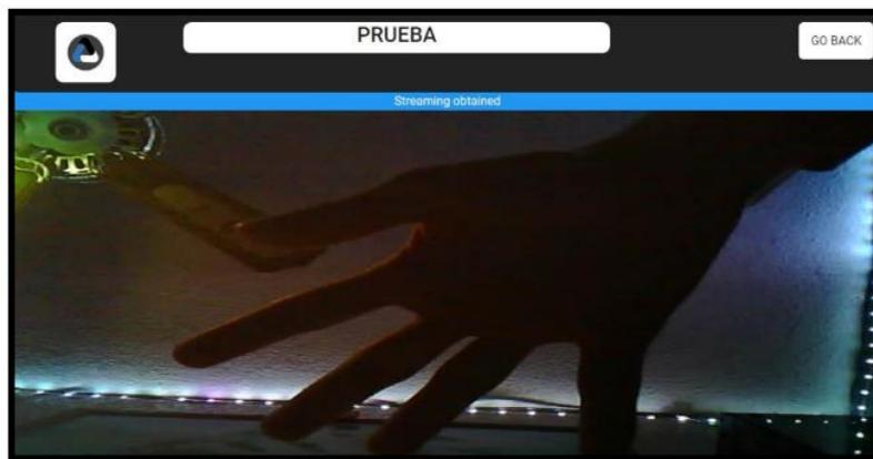
El equivalente de tener una toma cada 4 segundos nos indica una velocidad de fotogramas por segundo (FPS) de 0.25 FPS. A continuación, se adjunta el enlace al video con la primera prueba de video. En esta prueba, se sigue apreciando que el servidor no presenta problemas al estar mandando actualizaciones de imagen cada segundo, por lo cual se considera que se puede disminuir más el tiempo de refresco de imagen, como se observa en la Figura 18.
