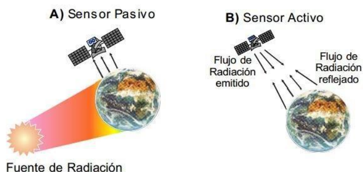
Figura 5. Tipos de sensores. (A. Sensores como ASTER, LANDSAT, MODIS Y SENTINEL. B. Sensores como LIDAR, Radar y Sonar)
