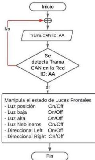
Figura 3.7 Secuencia lógica para ECU luces frontales
