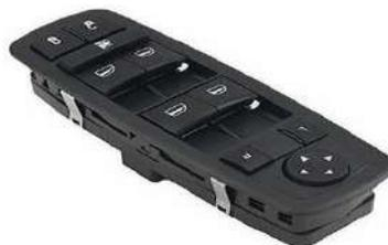
Figura 2.9 Mando central de pulsadores para el Elevalunas y Espejos eléctricos
