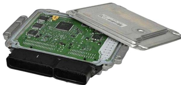
Figura 2.7 ECU de sistema de confort
