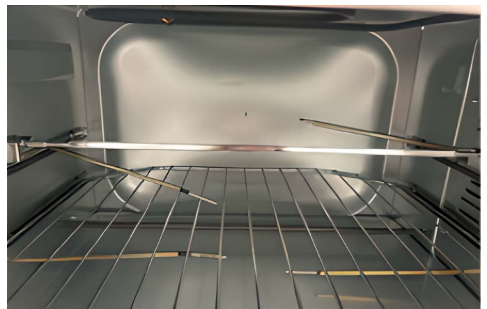
Figura 5. Interior del horno, 4 sensores PT100
