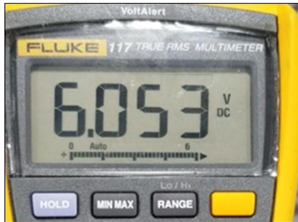
Figura 5.17 Prueba de Conector con Multímetro, Voltaje Correcto en Conector
