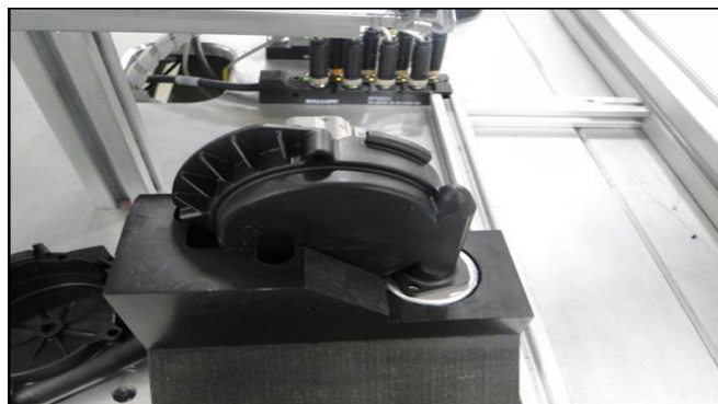
Figura 5.13 Fixtura para Atornillado
