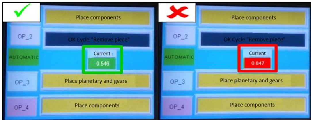
Figura 5.15 Izquierda: Motor con Corriente Aceptable. Derecha: Corriente de Motor Alta.
