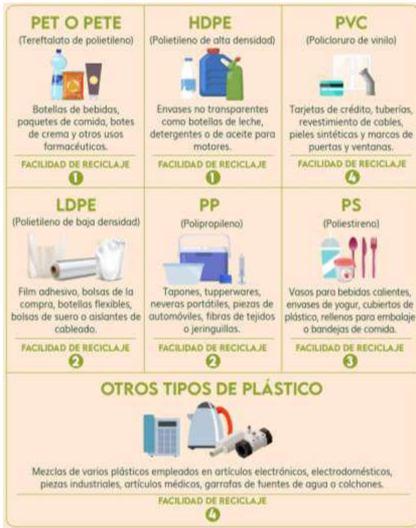
Figura 8. Clasificación y Aplicación de Plásticos, así como su facilidad de reciclaje. ( https://dkv.es/corporativo/blog-360/medioambiente/reciclaje/tipos-de-plasticos-clasificacion-reciclaje#toc-otros-tipos-de-plasticos ).
