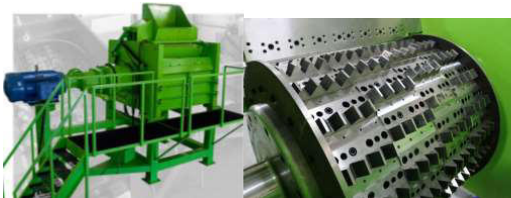
Figura 18. Rallador de llanta ( https://ecogreenequipment.com/ )
