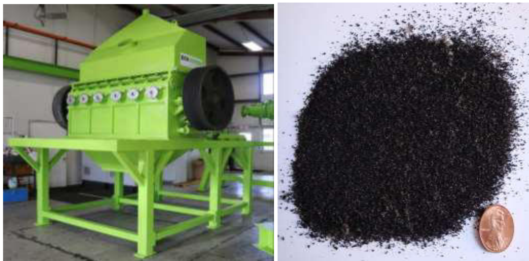
Figura 20. Granulador de caucho y resultado. ( https://ecogreenequipment.com/ )
