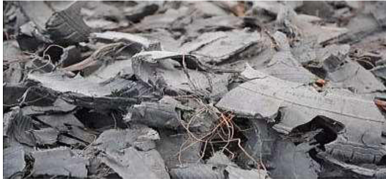
Figura 17. Resultado del primer nivel de trituración. ( https://ecogreenequipment.com/ )
