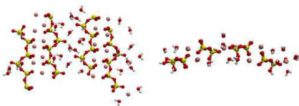
Figura 35. Estructura de la tobermorita 14 Å. Izquierda ) vista frontal, derecha ) vista lateral. Átomo/color: calcio/rosa, hidrógeno/blanco, oxígeno/rojo, silicio/amarillo.
