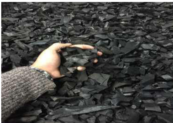
Figura 19. Resultado del primer nivel de trituración. ( https://ecogreenequipment.com/ )
