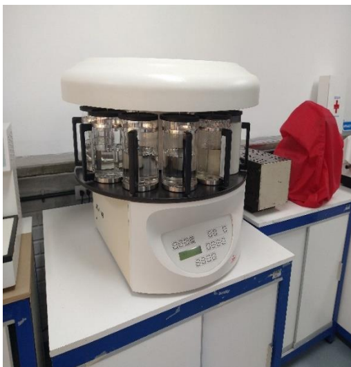
Figura 10. Estoquinate en función para la preparación del tejido para su proceso histológico (Tiempo de duración 11 horas).
