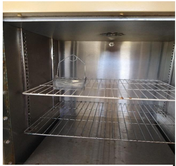
Figura 15. Estufa eléctrica con los portaobjetos dentro, a una temperatura de 56°C
