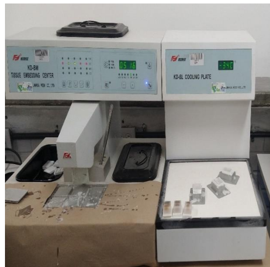
Figura 11. Sistema de embebido junto al plato de enfriamiento para su solidificación.
