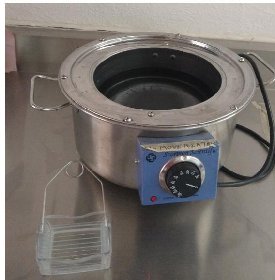
Figura 13. Baño maría donde se colocan las muestras del tejido embebido y poder seleccionar la muestra para procesar mediante H-E
