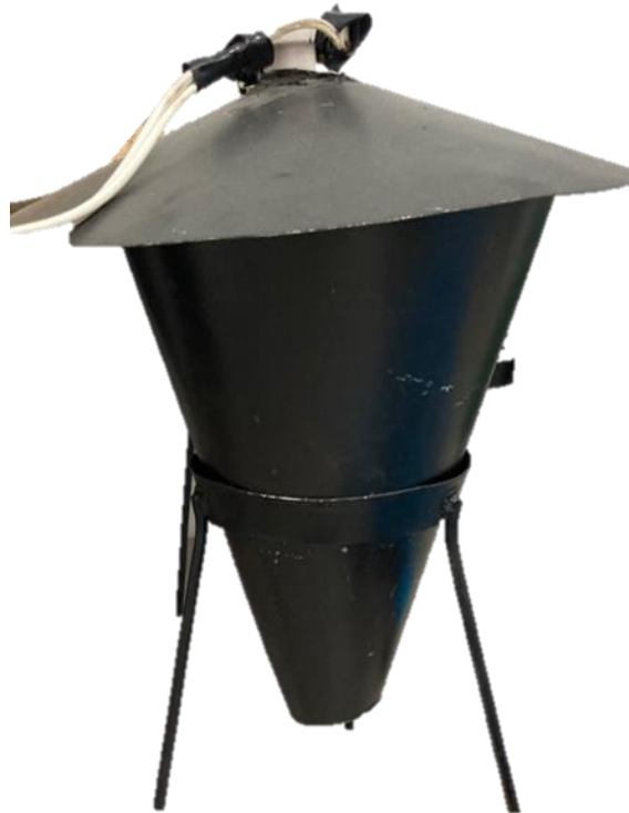
Figura 6. Método del embudo de Berlese.
