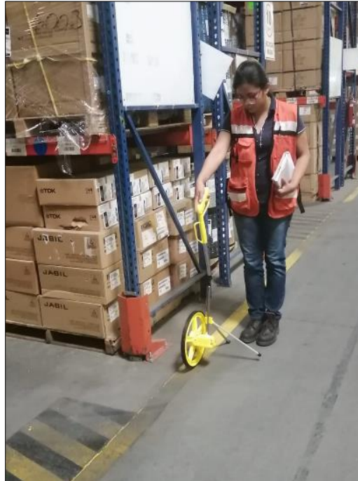
Figura 4.5 Medición del Área con Odómetro
