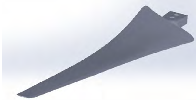
Figura 5.28. Aspa de 60 cm, importada a SolidWorks, para hacerla compatible con el software ANSYS.
