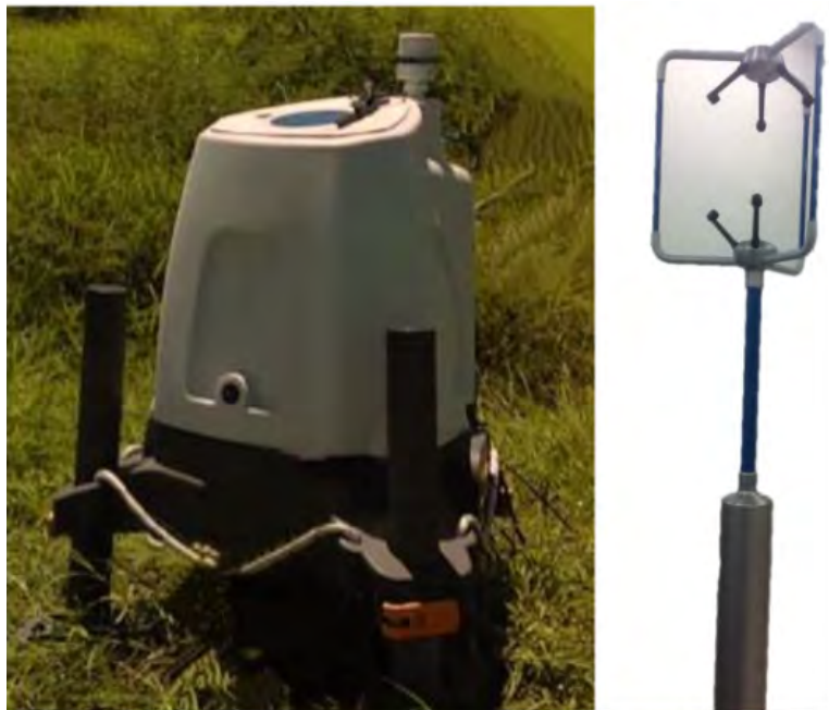
Figura 2.7. ZephIR LIDAR 300 (izquierda) y anemómetro ultrasónico 3D Gill WindMaster (derecha) [5].
