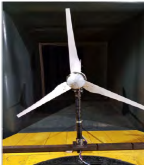
Figura 2.10. Prueba experimental, análisis de vibraciones en la torre de un aerogenerador de baja potencia [22].
