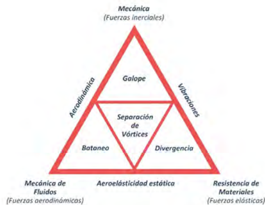
Figura 3.9. Triángulo de fuerzas que componen la aeroelasticidad [53].
