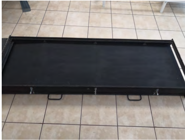
Figura 3.8: CSA con placa absorbadora y soportes de altura variable
