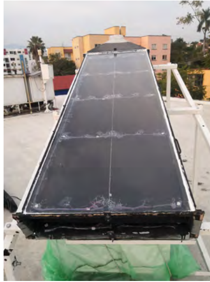
Figura 3.25: Sellado de la cubierta de vidrio
